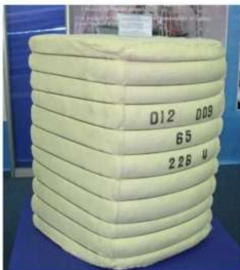
Рис. 1.10. Внешний вид кипы упакованной по традиционной технологии с применением металлической проволоки и нетканки
