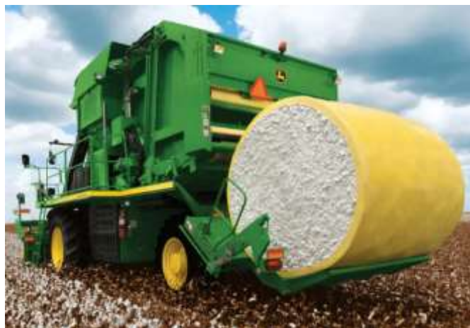
Рис.2. Использование полиэтиленовой плёнки для упаковки хлопка.
